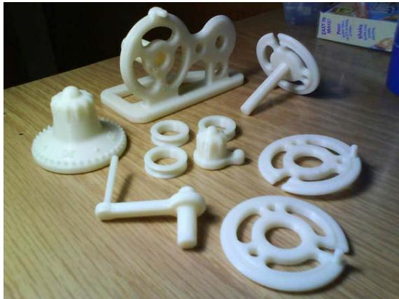
Je hitrostrjujoča polimerna masa , primerna za ulivanje preciznih delov modelov, prototipov, polizdelkov za kasnejšo CNC obdelavo, zalivna masa za elektroniko, lepilo ipd.
